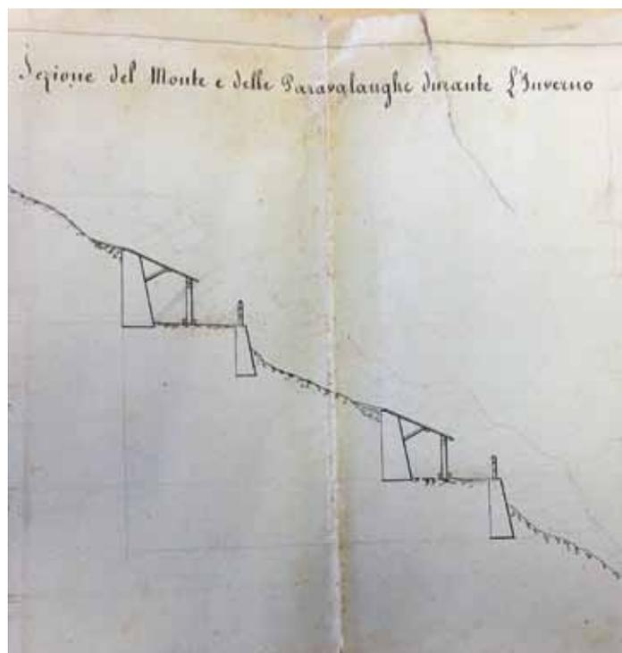
Sezione di coperture in legno sul profilo del monte
